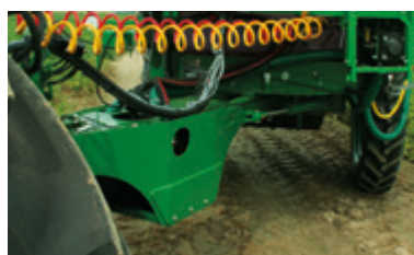
Automatic tracking drawbar działający na zasadzie żyroskopu, umożliwia precyzyjne kopiowanie śladów ciągnika w uprawach rzędowych oraz automatyczne lub manualne przestawienie na tzw. „psi chod”.
